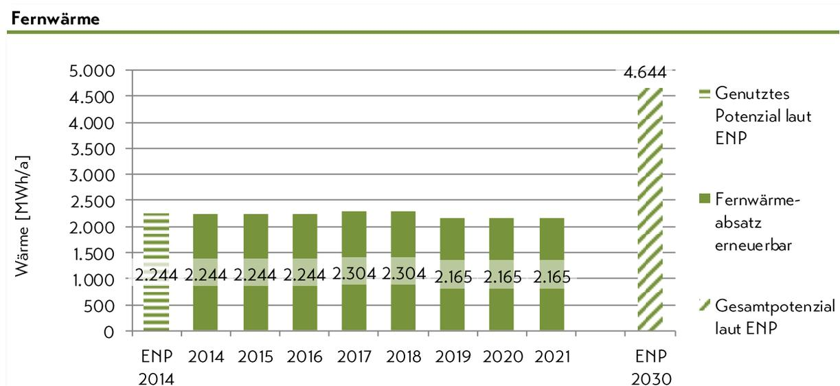
Abbildung 13: Fernwärmeabsatz auf Basis erneuerbarer Energien für den Zeitraum 2014 bis 2021 sowie das laut Energienutzungsplan im Jahr 2014 genutzte Potenzial und gesamte Potenzial bis 2030
