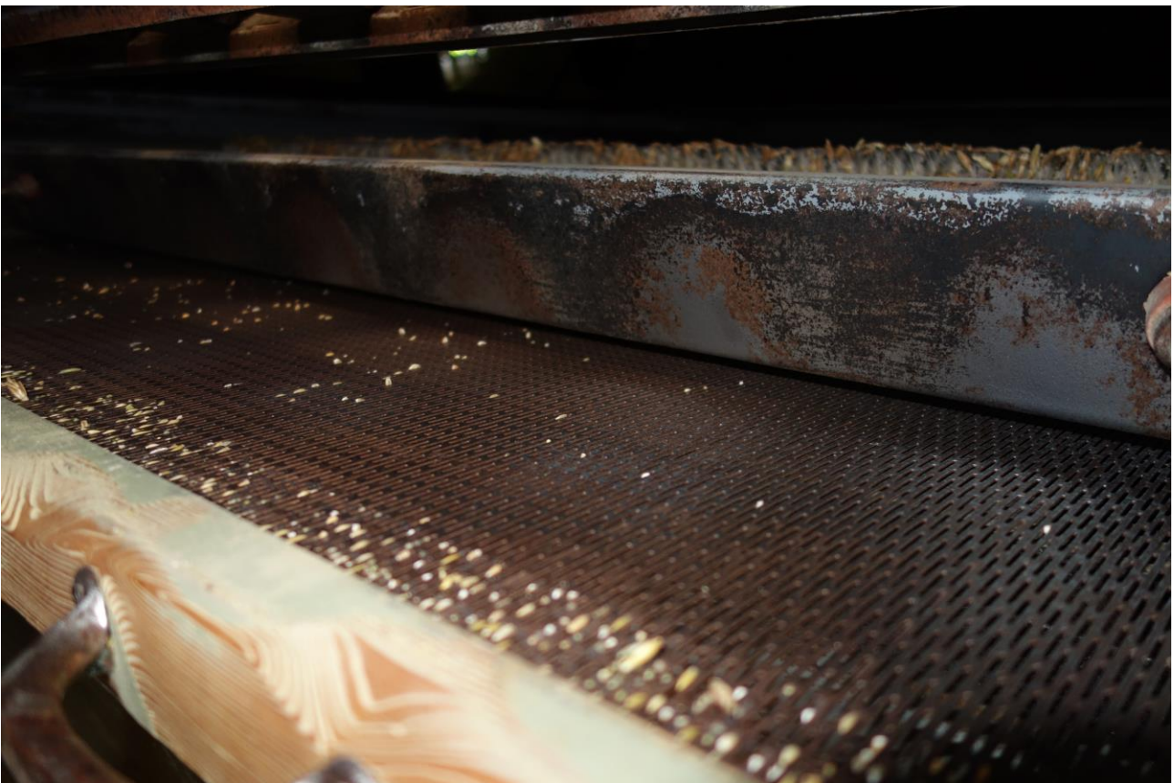
Ein Sieb in der Reinigungsmaschine. Zunächst wird das Ökogetreide vom Kleingetreide getrennt und in einem weiteren Schritt wird aus diesem der Leindotter herausortiert. Leindotter liefert ein sehr hochwertiges Speiseöl mit vielen mehrfach ungesättigten Fettsäuren. Foto: Mergenthal
