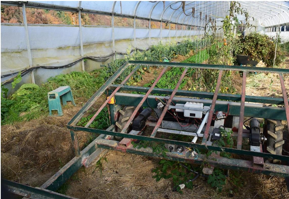
*Selbstgebaute elektroangetriebene Gartenbaumaschine. Foto: Standl*
