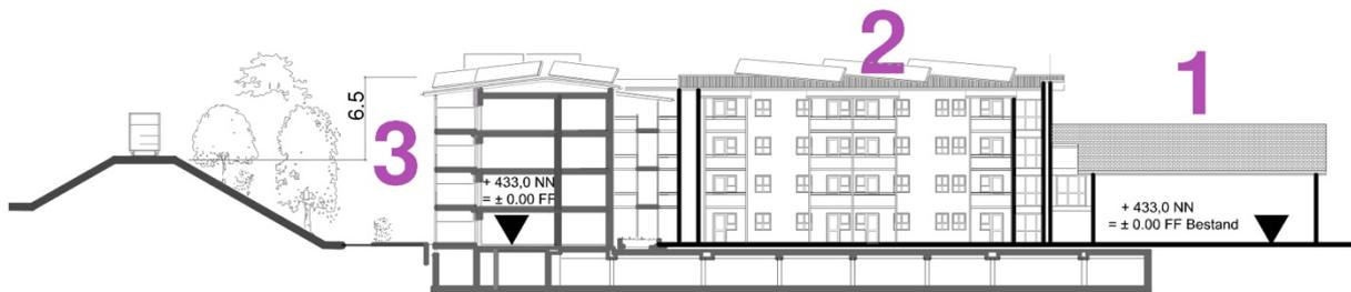
Der Baukörper des Süd – West – Flügels entspricht einer 6,5 m hohen Schallschutzmauer.
