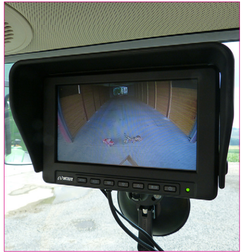
Ein Kamera-Monitor-System zeigt den kompletten Bereich hinter dem Fahrzeug.
